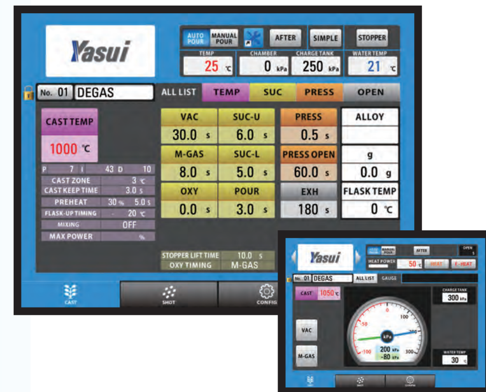
溶解室、鑄型室それぞれの 圧力値が表示される 精密マルチゲージ
